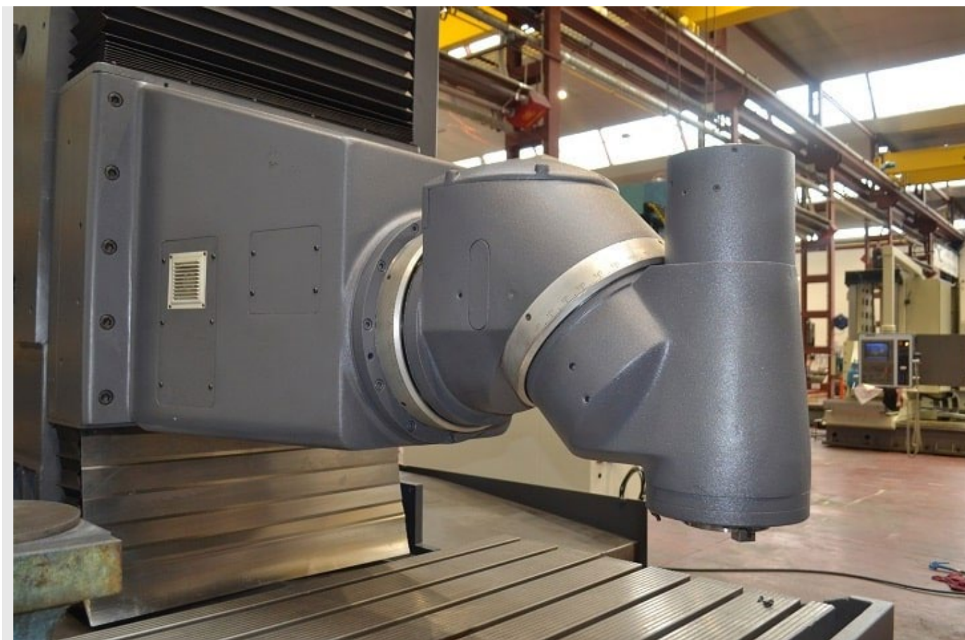
Detalle de cabezal BIRA durante la reconstrucción de fresadora ANAYAK HVM3300
