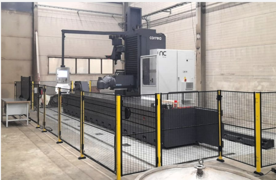
Ejemplo de fresadora CORREA L30/58 tras su total retrofiting con nuevo TNC
