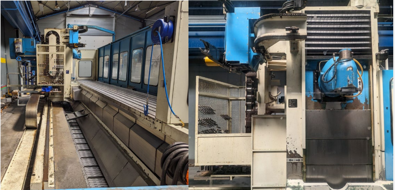
Fresadora CORREA L30/58 antes de su reconstrucción (en origen)
